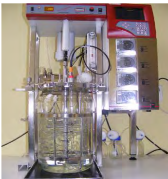
Figura 40. Bioreactor tip Fermac 310/60, Figura 41. Agitator tip turbină Rushton volum util 8 \cdot 10^{-3} \text{ m}^3
