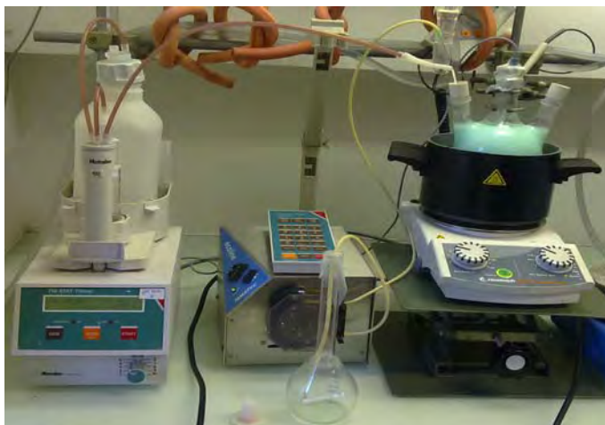
Figura II.1. Instalație pentru sinteza hidrotalcitului.
