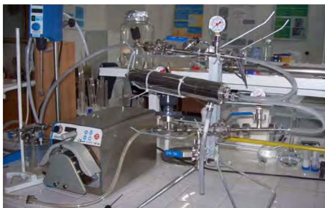
Fig. 2.6 Instalație de ultrafiltrare
