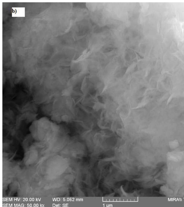
Figura IV. 25. Fotografii SEM pentru: a) Cr/MgAlLDH b)Cr/ZnAlLDH
