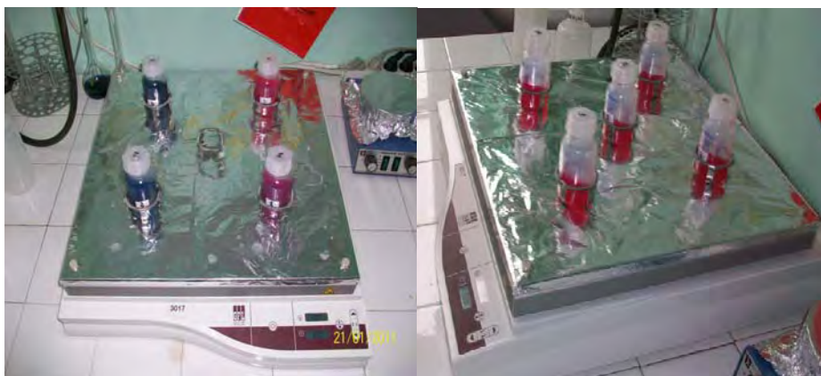
Figura IV.20. Reprezentarea agitatorului utilizat în studiile de adsorbție ale coloranților textili industriali pe hidroxizi dublu lamelari de tip ZnLDH
