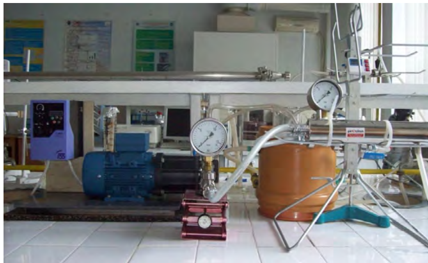
Figura 2.4. Sistem de nanofiltrare la scară de laborator
