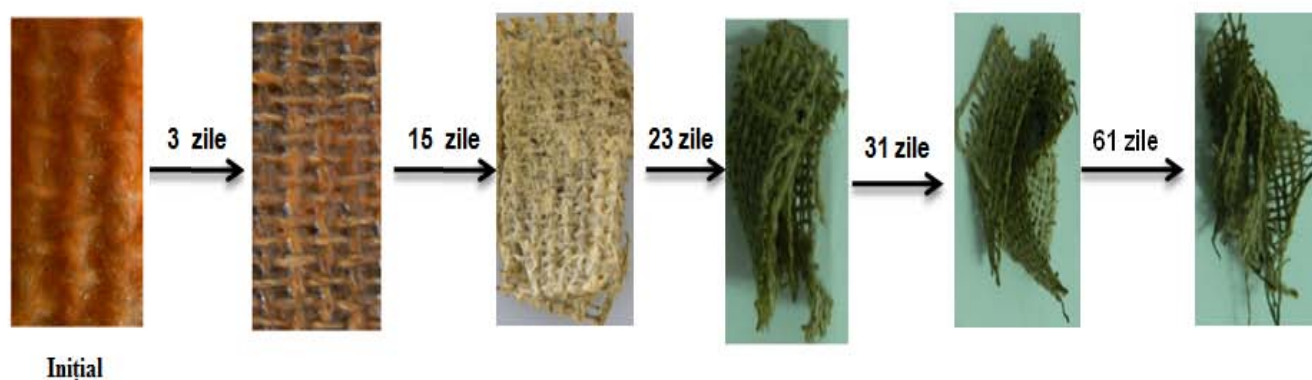
Figura 5.13. Etapele de degradare a probei CCP1
