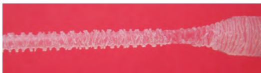
Figura 66. Epruvetă fisurată în timpul întinderii probei
