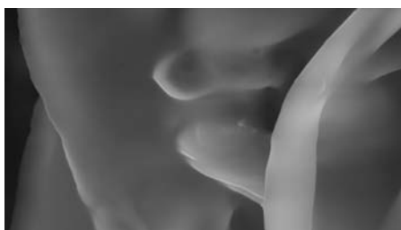
Figura 5.32. Imaginea ESEM a fibrelor impregnate cu proba de gel cu albastru de metilen
