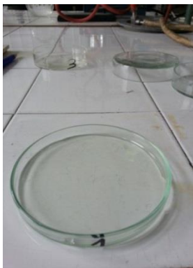
Figura IX.3. Turnarea filmului de acetat de celuloză
