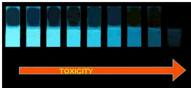
Fig. 4-4. Flacoane care conțin bacteriile luminescente cu o concentrație crescândă de substanțe toxice. Cu cât e mai toxică proba, cu atât e mai puternică inhibarea emisiei de lumină.
