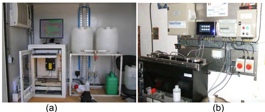
Fig. 4-5. Sistemul biologic (a) și cel convențional (b) de monitorizare a calității apei la captarea pe râul Prut
