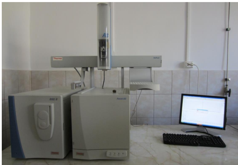
Figura 4.9. Sistemul DSQ II Thermo (Focus GC și spectrometru de masă DSQII).
