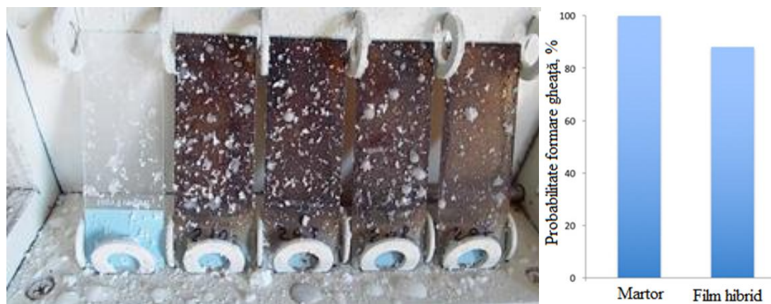
Figura 59. Fotografie a filmelor hibride în timpul testului cu ceață simulată și probabilitatea estimată de formare a gheții (64% umiditate, -18°C)
