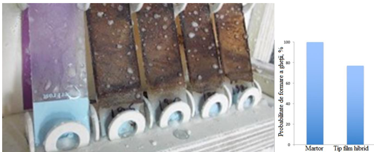
Figura 61. Fotografie a filmelor hibride în timpul testului cu ploaie înghețată simulată (stropire, -18^{\circ}\text{C} ) Probabilitatea estimată de formare a gheții scade față de metoda în ceață.
