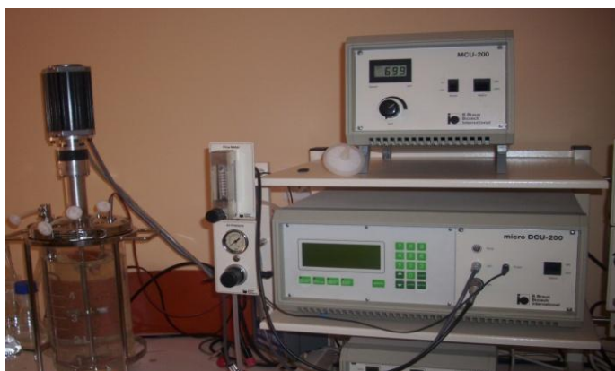
Figura III.1. Bioreactorul cu amestecare mecanică și strat mobil de biocatalizatori (tip Biostat A, volum total 5 l/volum util 4 l)
