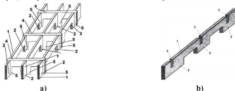
Fig. 5.6. a) Palet asamblabil și dezasamblabil (Câmpean, 2018): 1-elemente de susținere, 2-picioare, 3-îmbinări tip "mușcătură", 4-elemente transversale de susținere, 5-picioare ale elementelor transversale de susținere, 6-îmbinări tip "mușcătură" ale elementelor de susținere b) Element de susținere de bază
