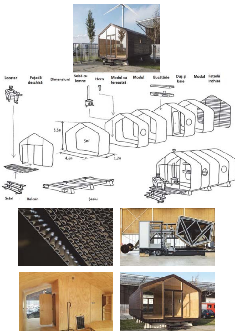
Fig. 3.7. Wikkellhouse (casa pachet) realizată din 24 de straturi de carton ondulat
